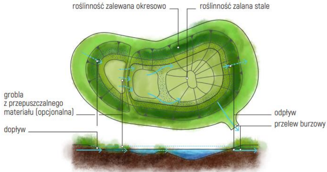
Rysunek 45. Schemat typowego stawu retencyjnego, widok z góry i przekrój
